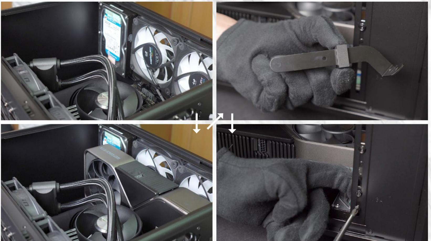
※GPU サポートステイを使用して固定します。
